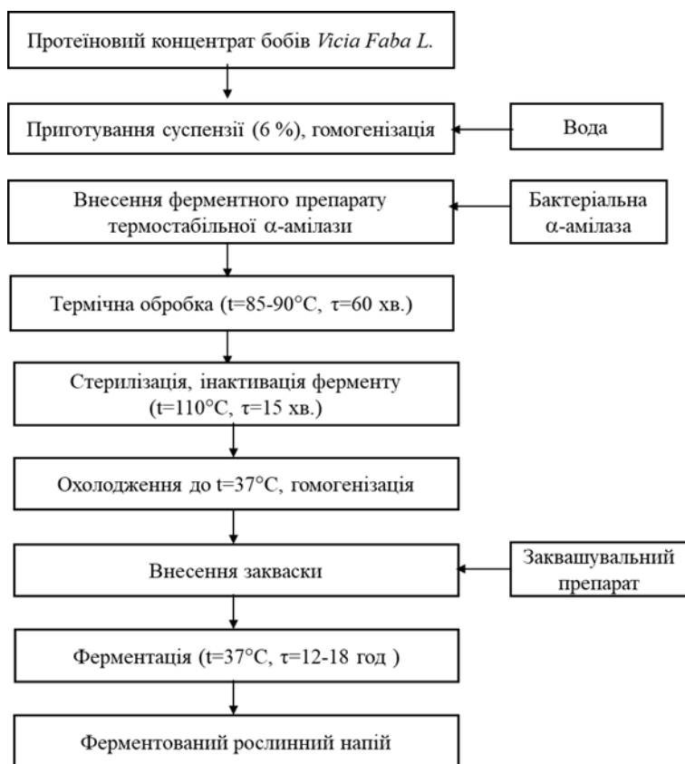
Рис. 1. Схема технологічного процесу отримання ферментованого напою на основі бобів Vicia faba
