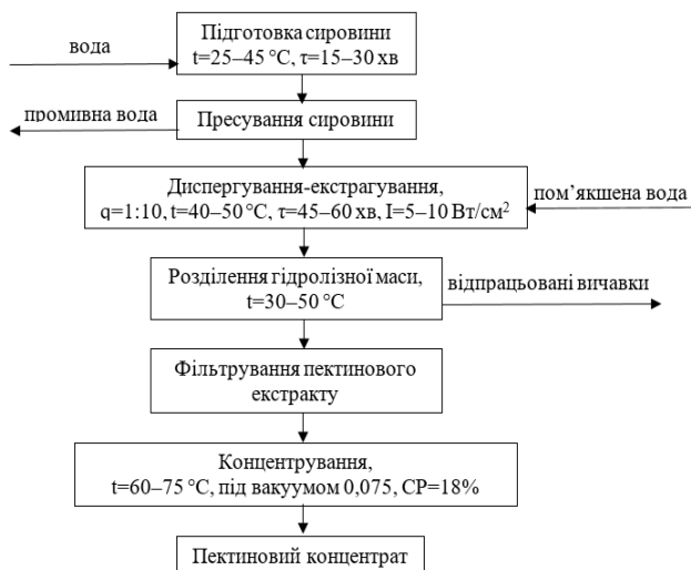
Рис. 1. Технологічна схема виробництва пектинового концентрату
