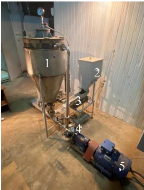
Рис. 4. Тепломасообмінна дослідно-промислова установка: 1 – приймальний бункер; 2 – ємність для сировини; 3 – вібродозатор; 4 – РПА; 5 – електродвигун
