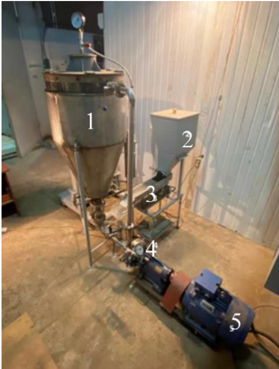
Рис. 5. Зовнішній вигляд модулю попередньої підготовки та робочі органи роторно-пульсаційного вузла роторно-пульсаційного апарата:
