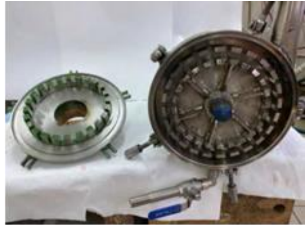
Рис. 5. Зовнішній вигляд модулю попередньої підготовки та робочі органи роторно-пульсаційного вузла роторно-пульсаційного апарата:
