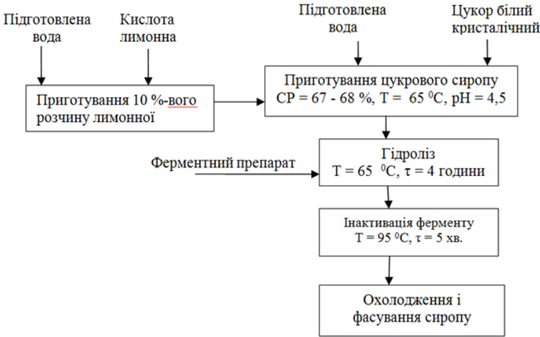
Рис. 4. Технологічна схема виробництва інвертного сиропу для підгодівлі бджіл
