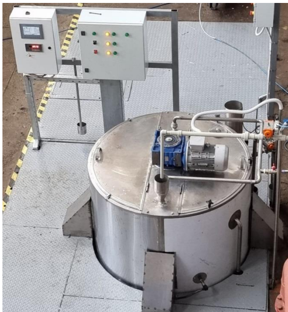
Рис. 5. Станція гідролізу цукру технологічної схеми виробництва інвертного сиропу, впровадженій на ТОВ «Новооржицький цукровий завод»
