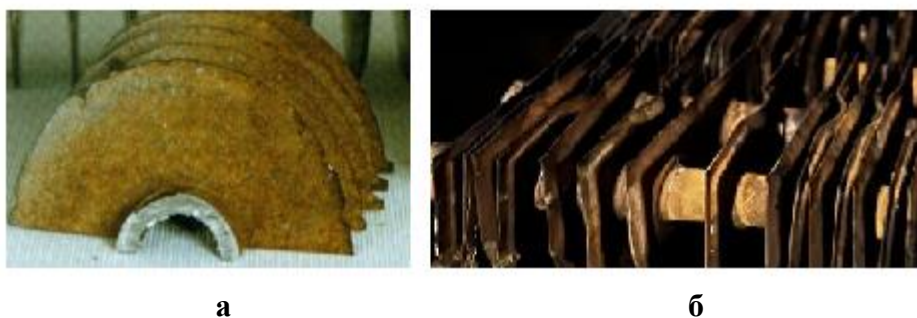
Рис. 3. Наслідки контакту хімічно агресивних компонентів диму з теплообмінною поверхнею випарника кондиціонера,
