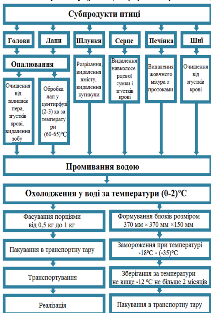
Рис. 1. Загальна технологічна схема оброблення субпродуктів птиці
