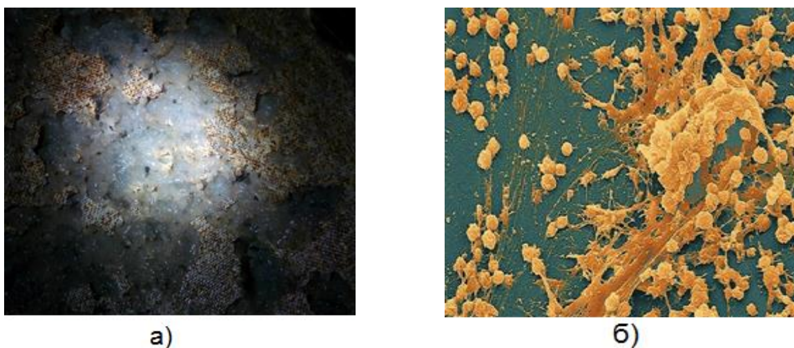
Рис. 1. Утворення біоплівки на обладнанні цукрового заводу - а); збільшення у 4 рази під мікроскопом зіскобу біоплівки - б).
