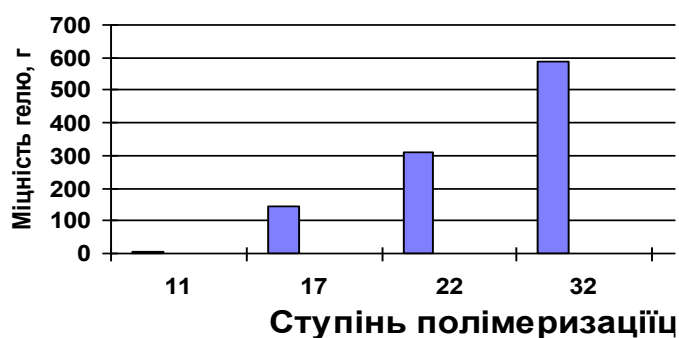
Рис. 7. Залежність міцності гелю від ступеню полімеризації
