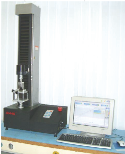
Рис. 2. Електромеханічна універсальна випробувальна машина SANS CMT2503
