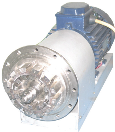
Рис. 4. Фотографія робочих органів подрібнювача м'ясної сировини Я5-ФПФ
