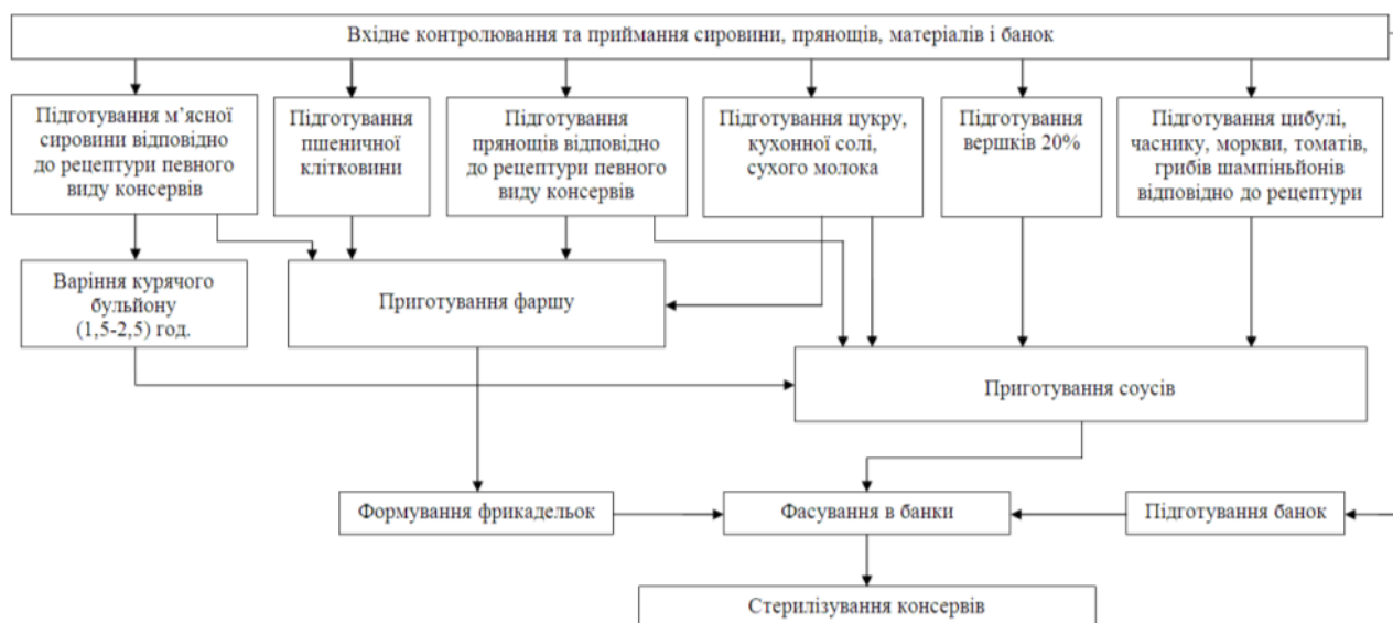
Рис. 2. Схема технологічного процесу виробництва фрикадельок
