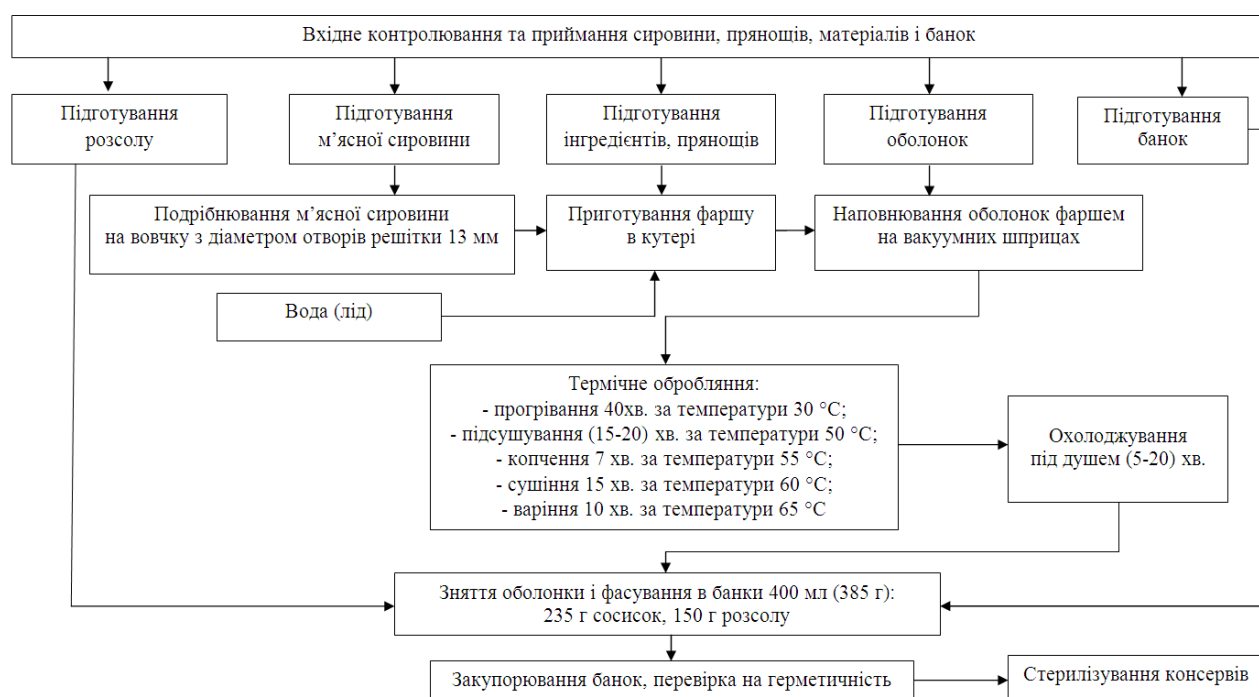
Рис. 2. Схема технологічного процесу виробництва фрикадельок
