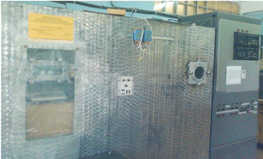
Рис. 1. Експериментальний стенд з конвективного процесу сушіння
