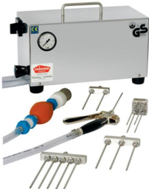
Рис. 1. Ручний ін'єктор розсолу – модель Rökelboy фірми Vakona (Німеччина)
